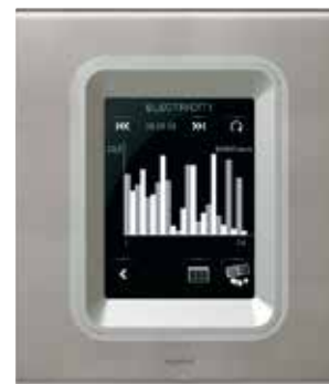
Οθόνη αφής 3,5" σε λειτουργία «ενεργειακή διαχείριση»
